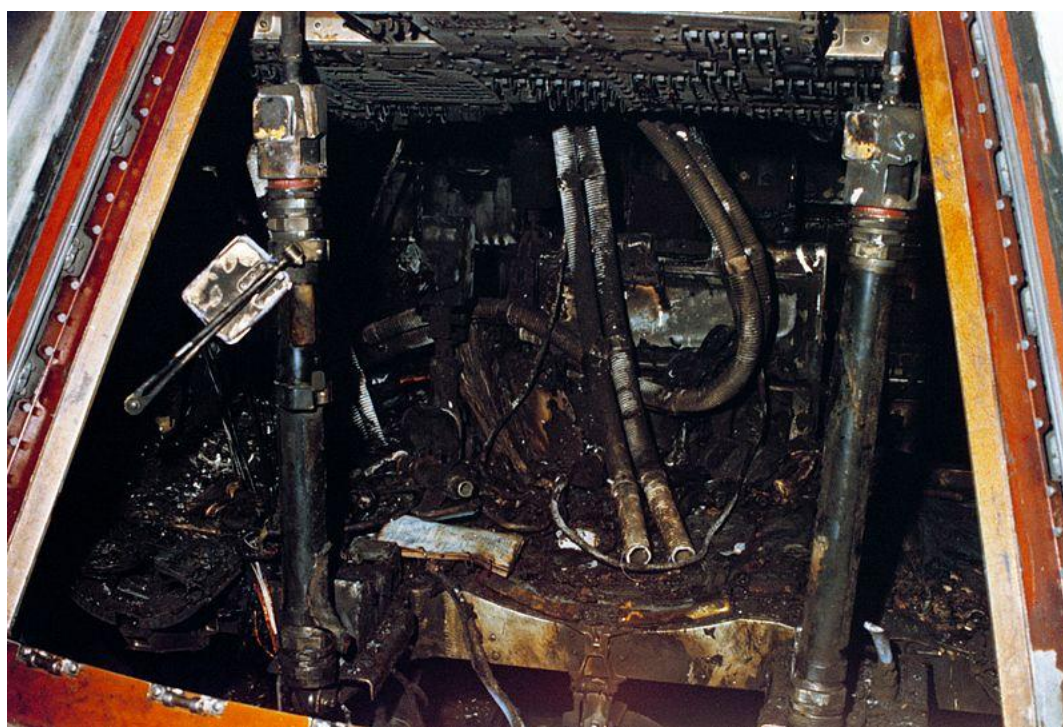
Pohled do kabiny po požáru
